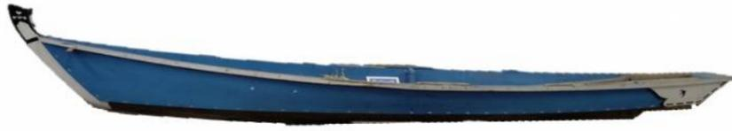
泊のカッコ船は、丸木舟より軽く波が入らず波に乗りやすく、多少の波でも操業できた。明治以降、丸木舟と併用する形で、カッコ船が使われるようになる。当初は、現在のカッコ船より少し大きく3から4人乗りで、長さは、23尺(約7m)で、幅3尺位(約1m)あった。船底部にムダマと呼ばれる材を用い、舷側板(棚板)を取り付けている構造である。ハギは、接ぎ合わせ、造船するという意味である。
